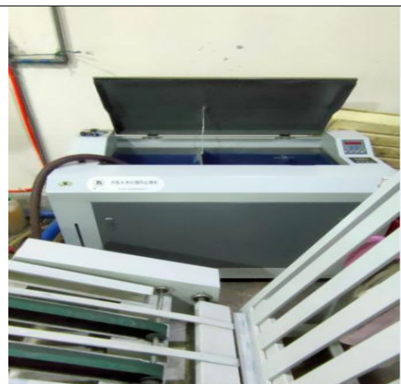
冲版废水循环净化设备
