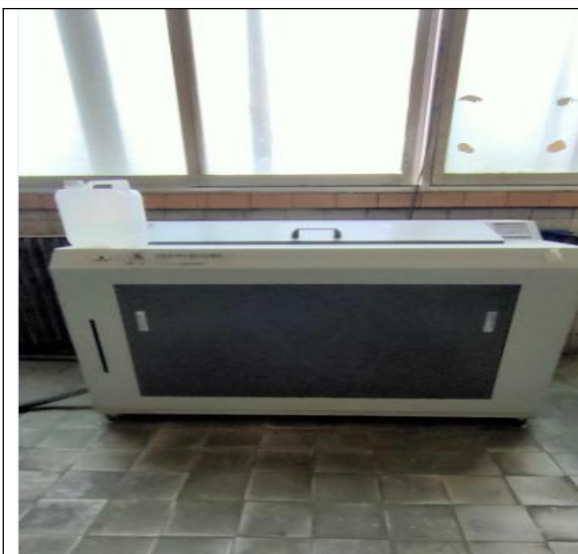
冲版废水循环净化设备
