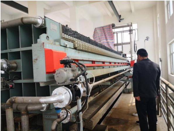
高压隔膜压滤机
